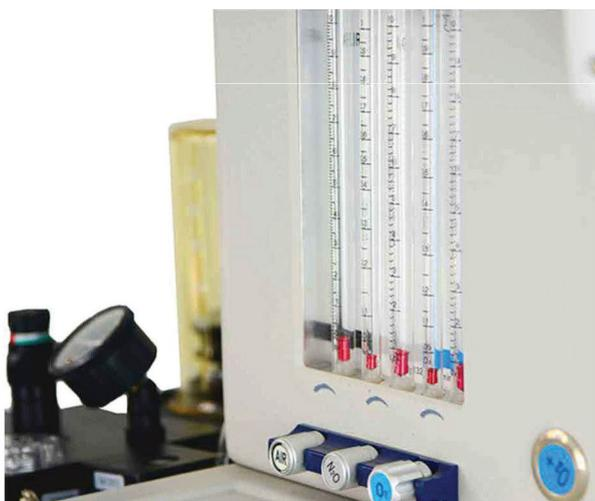
Débitmètre intégré à 5 tubes équipé de verrouillage O2 - N2O alimentation, garanties la sortie d'oxygène ne tombe jamais en dessous de 21%
